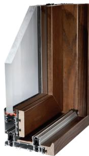
Slide 160 può essere realizzato anche come alzante scorrevole, con portata 250 kg per anta, oppure normale da 90 kg per anta. Il taglio termico garantisce un elevato sistema di isolamento dall'esterno, creando all'interno della propria abitazione una tranquilla zona di comfort indipendentemente dalle condizioni ambientali esterne. Il sistema permette la creazione di ampie superfici vetrate soddisfacendo l'esigenza di aria e luce naturale.
