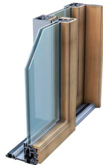
Slide 106 può essere realizzato anche come alzante scorrevole, con portata 250 kg per anta, oppure normale da 90 kg per anta. Il taglio termico garantisce un elevato sistema di isolamento dall'esterno, creando all'interno della propria abitazione una tranquilla zona di comfort indipendentemente dalle condizioni ambientali esterne. Il sistema permette la creazione di ampie superfici vetrate soddisfacendo l'esigenza di aria e luce naturale.
